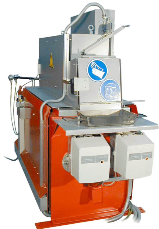
Ansicht der Brenner des Zink Schmelzofen ZSOR850B - View of the burners of the Zinc melting furnace ZSOR850B
