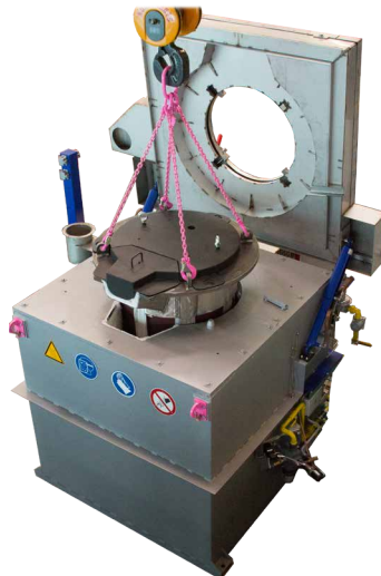
Universal Tiegel Ofen UTO (Tiegelüberführung von UTO in USB) - Universal crucible furnace UTO (crucible transfer from UTO to USB)
